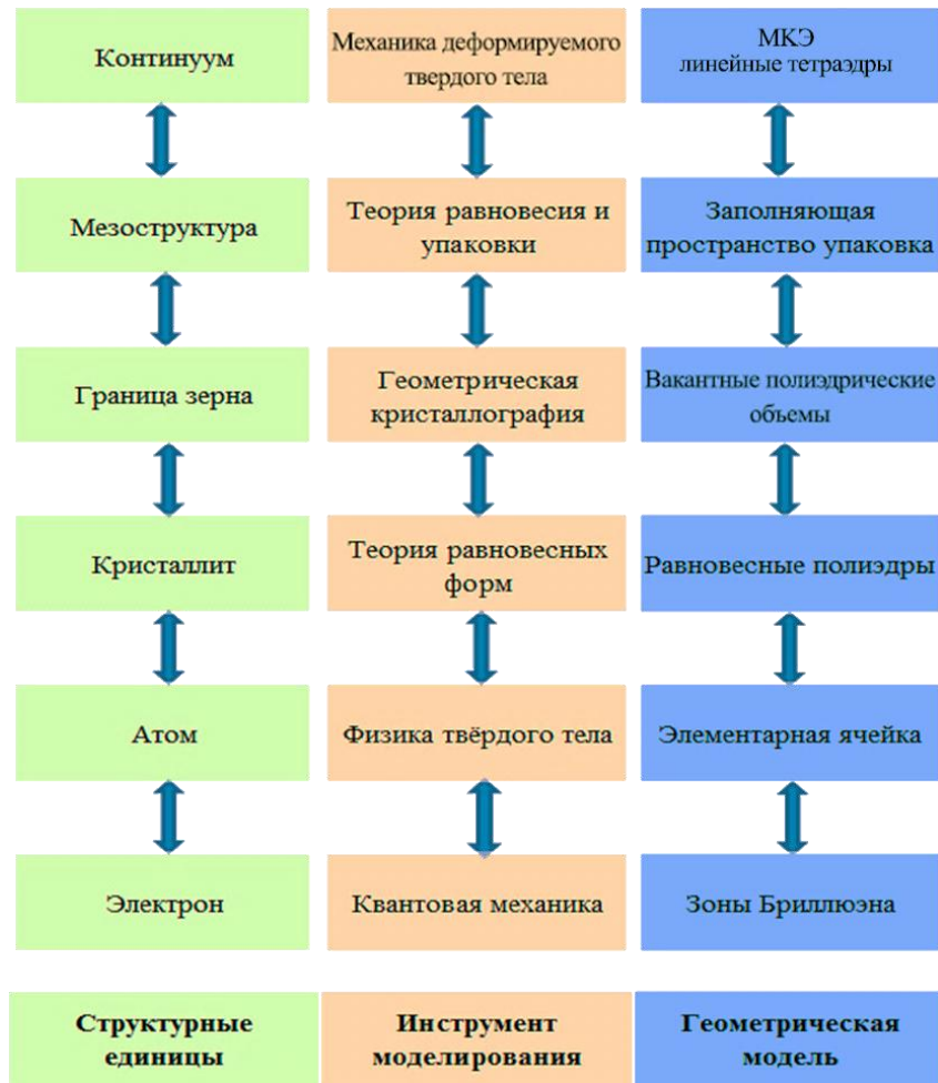
Рис. 2. 3D структурно-геометрические уровни пространственного строения металлических материалов с инструментами их моделирования и геометрическими моделями
