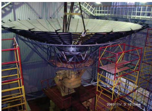
Рис. 3. Испытания космического радиотелескопа КРТ-10 на полигоне ПРАО АКЦ ФИАН (Пушинской радиоастрономической обсерватории Астрокосмического центра ФИАН)
