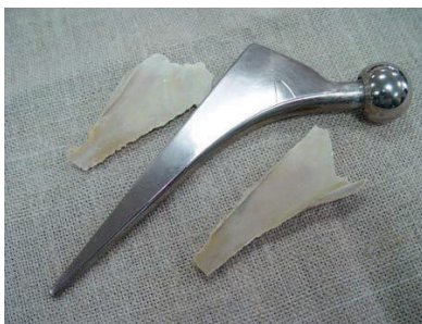
Рис. 4. Ножка и головка эндопротеза тазобедренного сустава из титанового сплава ВТ6 с коррозионно- и износостойкой поверхностью и с фрагментами цементной мантии после 6 лет эксплуатации в организме человека: износ всех компонентов отсутствует
