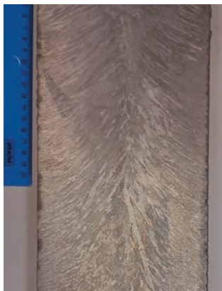
Рис. 2. Макроструктура слитка ЭЖ79-ИД в продольном направлении после замены кристаллизатора
